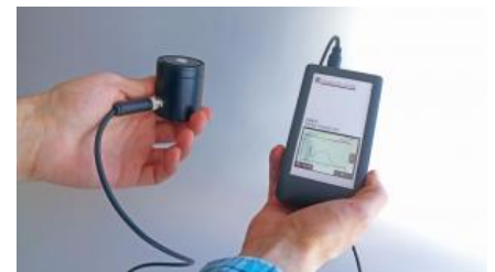
Verwendung des CSS-45 als Handmessgerät durch Kombination mit der Kontrolleinheit CSS-D
