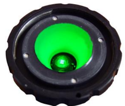
Die konisch geformte Messöffnung wird über die Test-LED gestülpt und erfasst sämtliche Strahlung im 2\pi Raum
