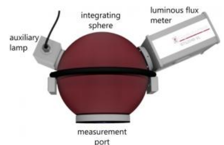
Direkte Montage des Messgerätes mit Zubehör
