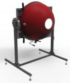
Hochwertiges CCD-Sensor Spektralradiometer BTS2048-VL mit drehbarer Ulbricht'scher Kugel ISD-100HFT.
