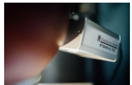
BTS2048-VL-TEC hoch genaues CCD-Sensor Spektralradiometer für CW und Pulsmessungen.
