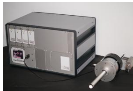
Ulbrichtkugel Lichtquelle Modell ISS-8P-RVA-ROD mit optionaler Steuerelektronik.
