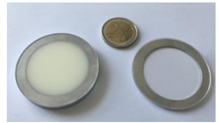
Küvette des SphereSpectro 150H-Systems mit spezieller Form und kleinen Abmessungen zur direkten Befestigung am Messanschluss
