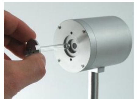
Foto 7: gestreckte Ulbrichtkugel für seitlich abstrahlende Lichtleiter. Inklusive Schutzröhrcheneinsatz.
