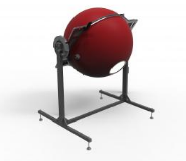
Durch Drehen der Kugel lässt sich die Betriebslage der Testlampe ändern.
