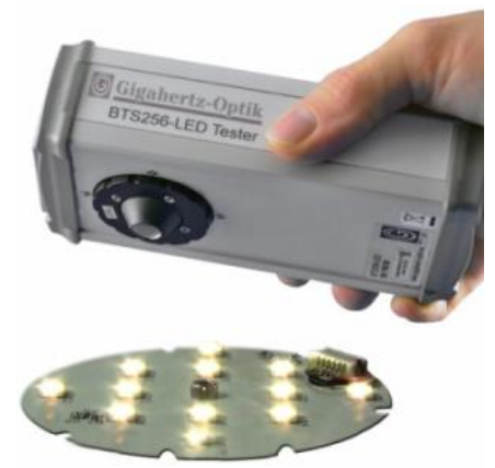
BTS256-LED zur Vermessung von Lichtstrom, Spektrum, Farbe und Farbwiedergabe von Einzel-LEDs
