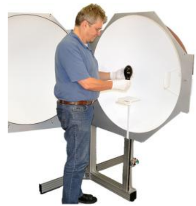
BTS256-LED Tester mit 1m Durchmesser Ulbrichtkugel
