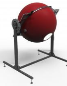
Die Position der Testlampe wird durch das Drehen der Ulbricht'schen Kugel eingestellt.
